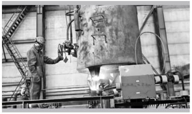
Идёт заливка печи расплавом магния
