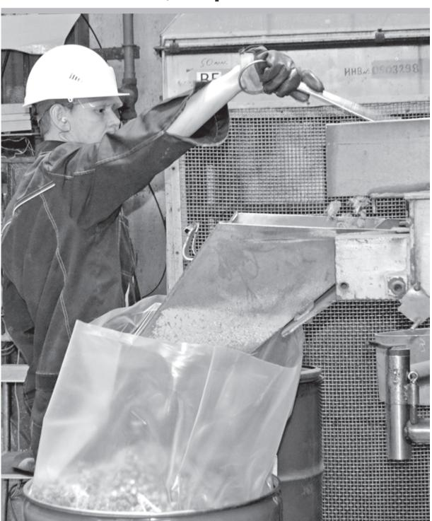
Узел выгрузки готовой продукции – конечный «пункт» большого и сложного процесса титанового производства цеха № 9. Затаривание титановой губки в бочки (ровно 250 «кило», без грамма отклонений – основное требование!) отслеживает Денис Хутный, бригадир раздельщиков титановой губки. А весь путь «превращения» исходного сырья в красивый стратегический металл – на нашей 3-й полосе.
